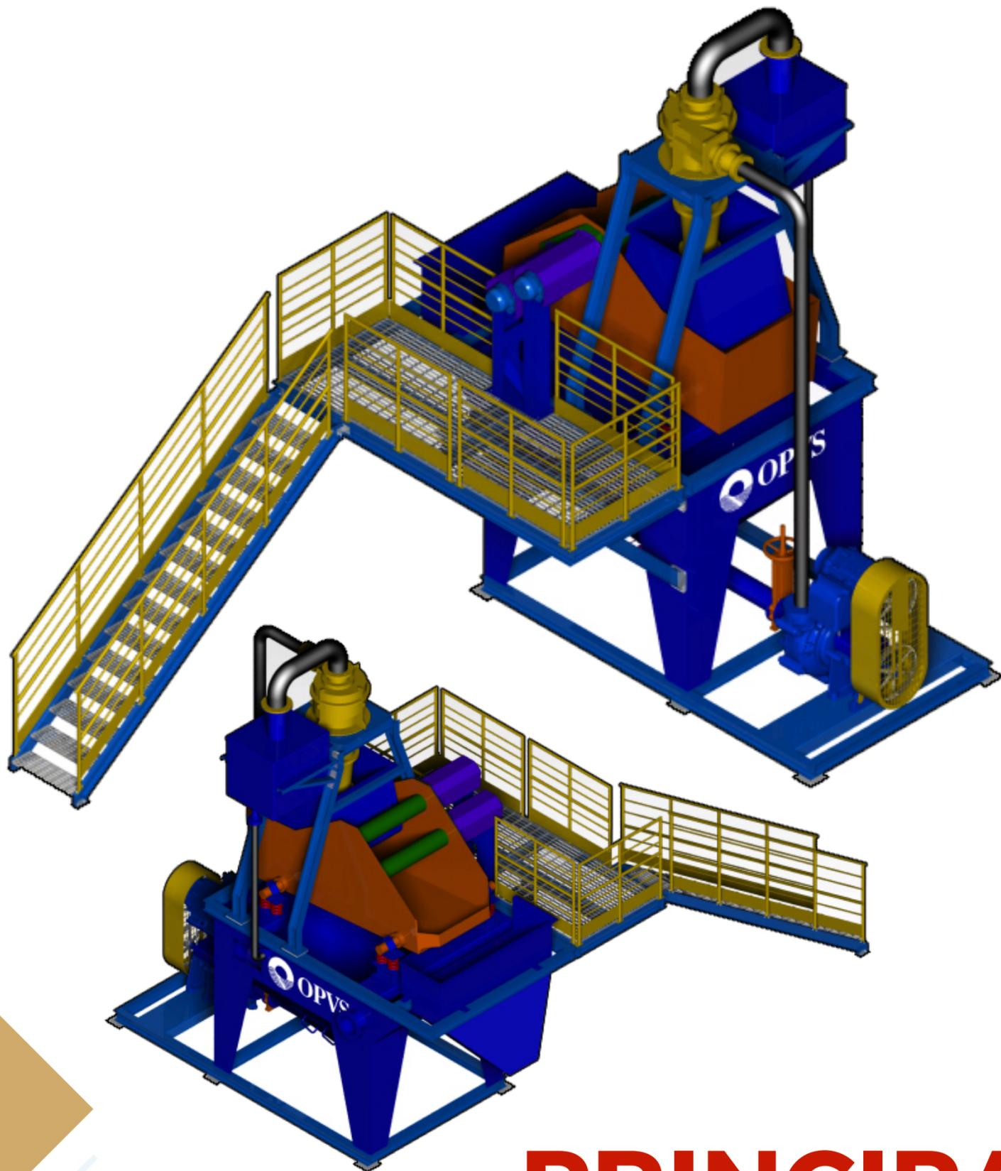
Estes sistemas são projetados e construídos, para fornecer areia limpa com baixo teor de umidade, com a alta qualidade.
