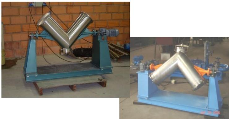
Nas tarefas de homogeneização de dois ou mais materiais sólidos granulares ou pulverulentos, os Homogeneizadores tipo “V”, produzidos pela OPVS, são a solução adequada e eficaz. Através da contínua divisão do material, em duas partes, que tornam a se reunir, a cada ciclo do recipiente em “V”, a mistura é feita rapidamente, gerando um produto bastante homogêneo.
