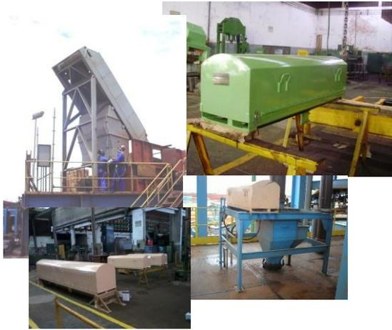
O Amostrador Automático Linear OPVS é adequado para a amostragem de materiais granulares ou empolpados. Indicados para a instalação em pontos de transferência desses materiais, é o equipamento apropriado para a amostragem em correias transportadoras e dutos. A coleta das amostras, que são efetuadas por nossos Amostradores, não interfere na operação dos transportadores, nem interrompe o fluxo dos produtos amostrados.
