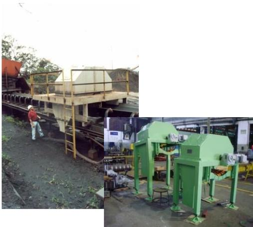
Uma solução prática, para amostragem de material granulado, em transportadores de correia, com ponto de transferência difícil, é o Amostrador "Cross-Belt" OPVS. Com instalação facilitada pela simples inserção do equipamento, diretamente sobre a correia, dispensando alterações nos chutes de transferência. Disponíveis para quaisquer larguras de correias, desde 24" até 84" ou mais.
