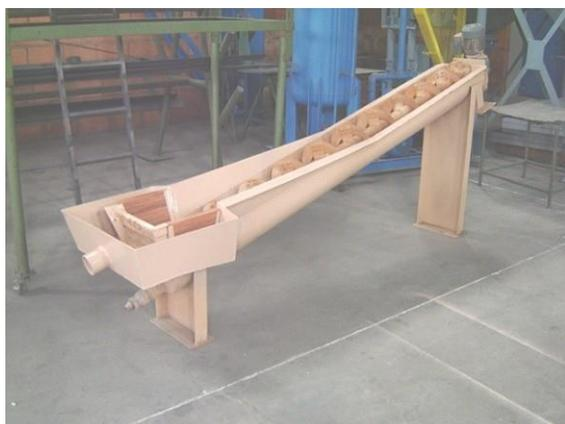
Os Classificadores Espiral OPVS foram projetados para atender, com grande eficiência, nas operações de classificação, deslamagem, desaguamento e lavagem de minérios. Produzidos em diâmetros que variam de 6 a 16 polegadas, podem ser empregados, desde o laboratório, até a planta de p iloto. Equipados com hélices revestidas, com material altamente resistente à abrasão, tem longa vida operacional, com grande facilidade de manutenção.
