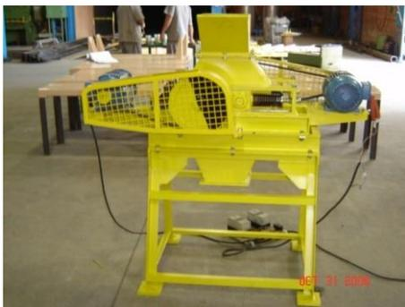
Os Britadores de Rolos OPVS são os equipamentos adequados para as reduções de granulometria dos materiais britados pelos Britadores de Mandíbula, preparando as amostras para as operações de moagens subsequentes. São duráveis e práticos de operar, permitem ajuste da distância entre os rolos, para o ajuste da granulometria do produto.
