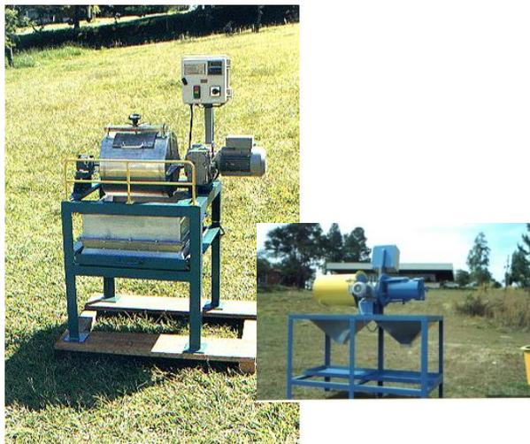
De emprego, tanto para laboratório, como para plantas piloto, os Moinhos para Laboratório produzidos pela OPVS podem ser empregados em moagens a seco ou a úmido, empregando barras ou bolas. Disponíveis em diversos modelos, nos diâmetros de 12 e 16 polegadas, podem ser montados com 1 ou 2 cilindros, com comprimento de 12 ou 16 polegadas. O modelo 12X12 polegadas é utilizado para a determinação do Índice de Bond (Wi).
